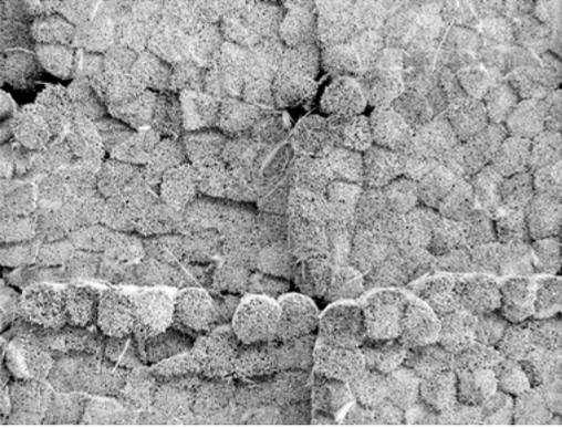
*Einzelbunde in Großbunden zusammengefasst. Durch die hohe Verdichtung in den Großbunden, die durch das Übereinanderstapeln weiter verstärkt wird, sind die Reethalme einer hohen mechanischen Beanspruchung ausgesetzt. Die Einzelbunde verlieren dabei ihre ursprünglich runde Form und füllen die Freiräume zwischen den Bunden aus. Nasses Material kann unter diesen Umständen nicht nachtrocknen.*
